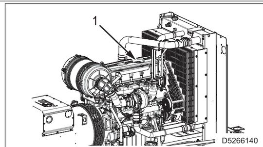
2 - Effectuer le remplissage et mettre le bouchon.
